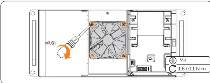
Figure 7-6 Installing a new fan
